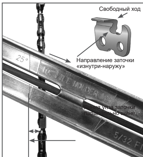
Рис. 22 Расположение линии угла заточки
