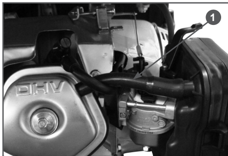
Рис. 13 Трубка системы вентиляции картера
