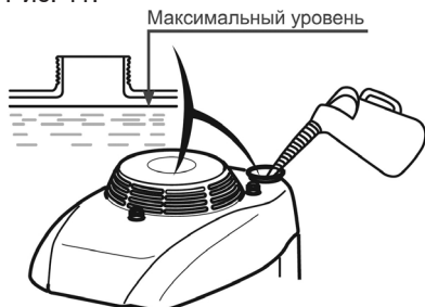
Рис. 11 Максимальный уровень топлива в топливном баке
