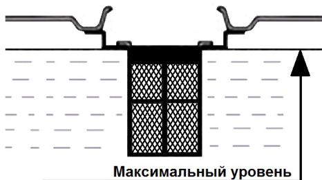
Рис. 10 Максимальный уровень топлива в топливном баке
