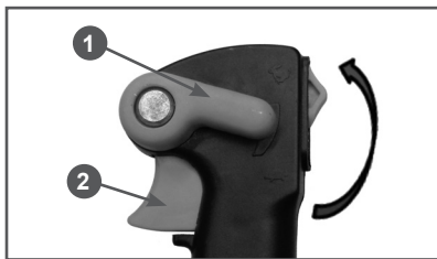
Рис. 16 Фиксатор рычага газа и рычаг газа 1 - Фиксатор рычага газа 2 - Рычаг газа
