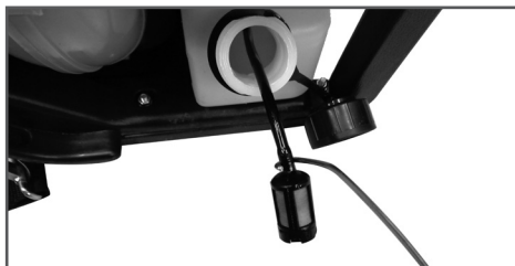
Рис. 22 Извлечение топливного фильтра
